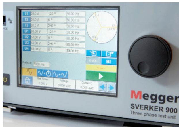
Autonomní funkčnost v terénu. Díky vestavěné dotekové LCD obrazovce a zásuvce USB přístroj SVERKER 900 nepotřebuje počítač.
